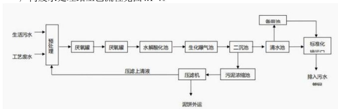
图4.1-4废水处理站工艺流程图
